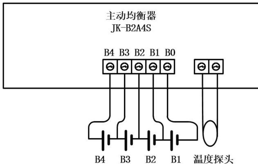
图 5 外部均衡接线
