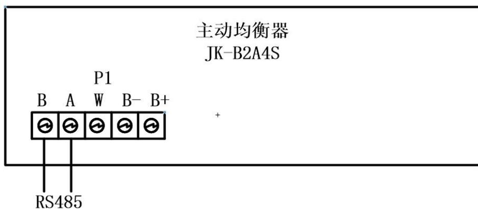
图 4 RS485 通信接线图示
